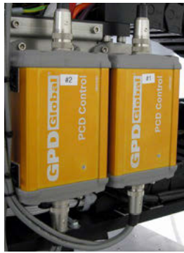
图6：两个控制接口单元安装在设备上
